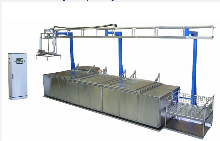
Установка ультразвуковой дезактивации
